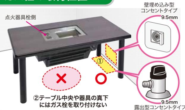
■ガス栓は、点火つまみの向かい側(図①)に取り付けてください。壁埋め込み形のコンセントタイプや、床面露出タイプなど、店舗の設計や使用環境に合わせて取り付けてください。
